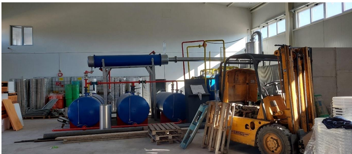
Slika 17. Uljno postrojenje za prečišćavanje pirolitičkog ulja
