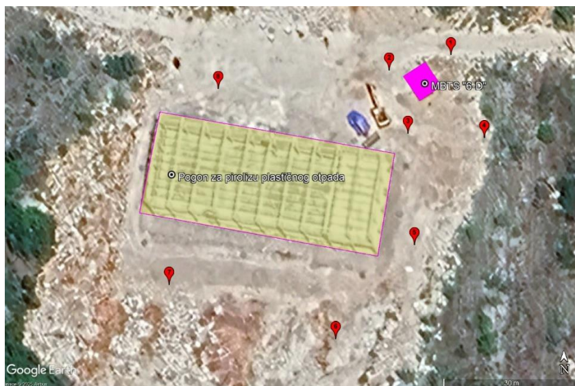
Slika 42. Prikaz mjernih tačaka u neposrednoj blizini MBTS "6-D", naponskog nivoa 10 (20)/0.4 kV
