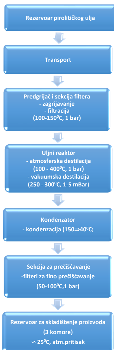
Slika 20: Blok dijagram tehnološkog procesa za prečišćavanje pirolitičkog ulja
