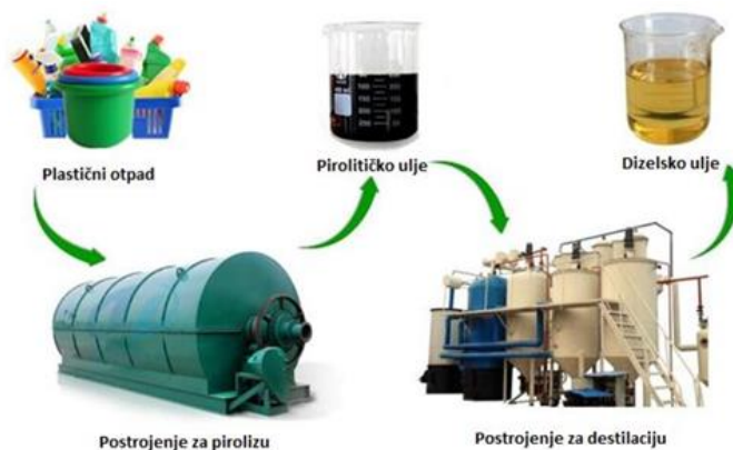
Slika 1. Slikovit prikaz procesa proizvodnje dizel goriva iz otpadne plastike
