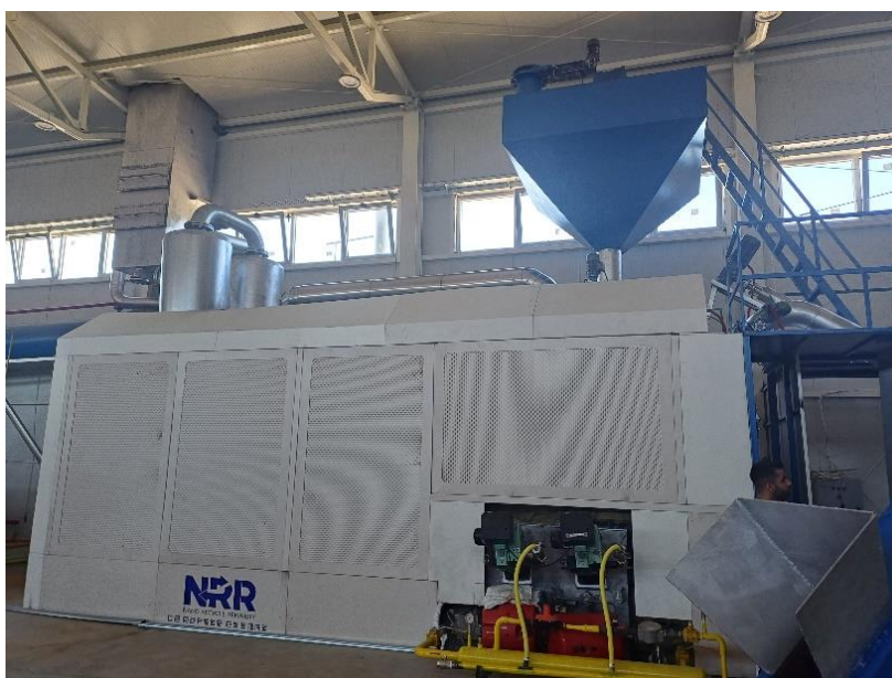
Slika 8. Reaktor za pirolizu
