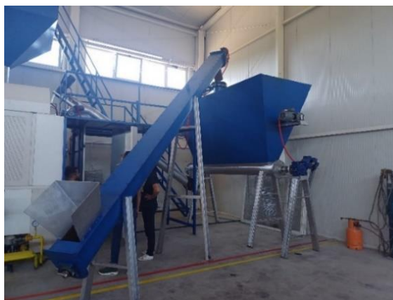
Slika 9. Dozator otpadne plastike sa pužnim transporterom
