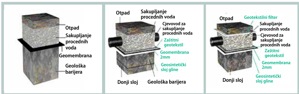
Slika 3.7 Prikaz donjih slojeva deponije
