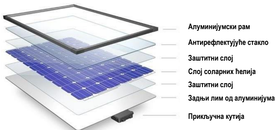
Слика 1. Типична конструкција соларног панела.
